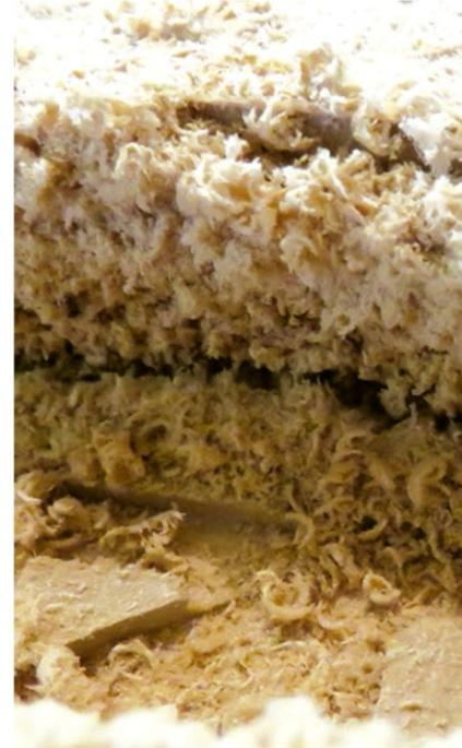
de corte, a los efectos de generar una viruta con cuerpo que "refrigere" la fresa y al mismo tiempo baje el rozamiento por fricción.
